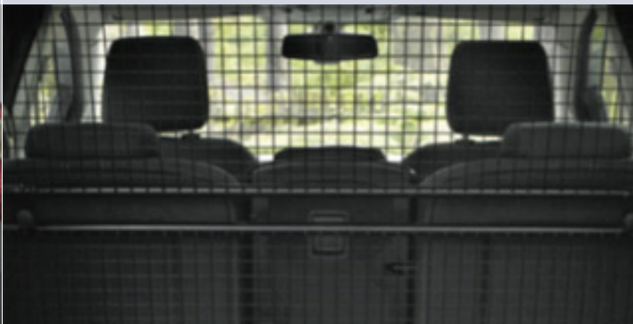
Paroi de séparation pour le compartiment de chargement, mi-hauteur
